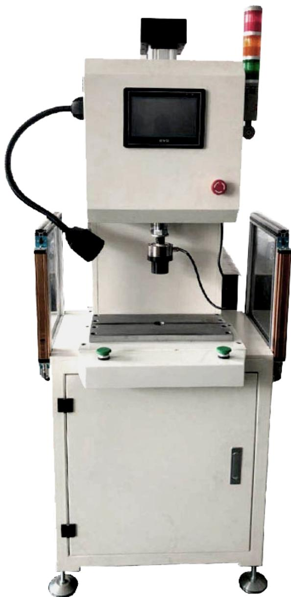
内置的精密压力传感器和编码器能精确测量速度，压力和位置。专业开发的控制软件可保证全过程精确控制压装力，停止位置。压装速度和保压时间等参数。达到全过程数字化管理
